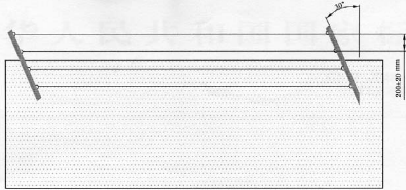
图 B.3 实体围墙 4 线斜装效果图
